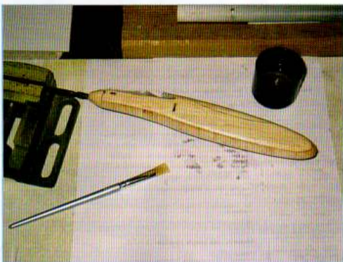
Un tissu de verre 80 g/m 2 renforce le fuselage sans pour autant beaucoup l'alourdir, car du lest est nécessaire pour assurer le centrage.
