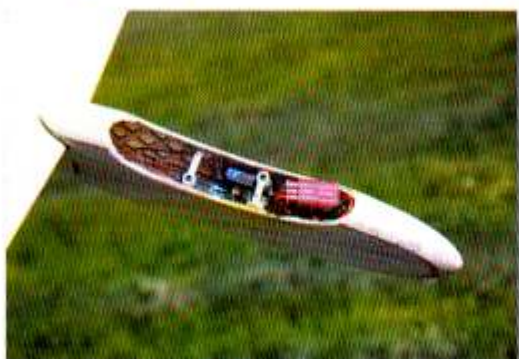
La radio doit être du plus petit volume possible, à tel point que la prise de l'accu semble «énorme» !
