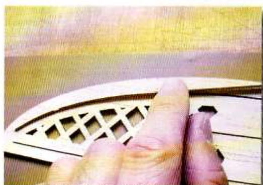
Les empennages sont renforcés par des plats de carbone insérés dans le balsa.
