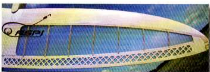
L'entoilage transparent laisse le travail sur la structure visible.
