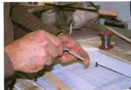
25) Le longeron-tube peut être manchonné avec un morceau de tube alu côté emplanture.
