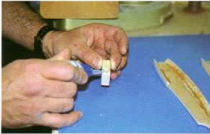
4) Le couple arrière percé au \varnothing 6 mm est collé contre le bloc de balsa
