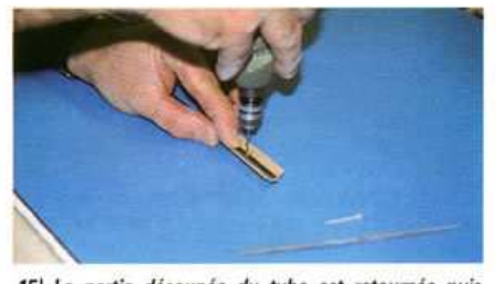
15) La partie découpée du tube est retournée puis posée sur le support. L'ensemble est percé au \varnothing 2 mm.
