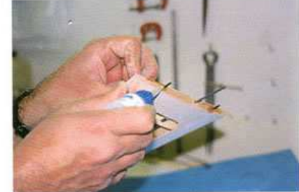
39) Collage des têtons d'incidence.
