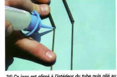
24) Ce jonc est glissé à l'intérieur du tube puis plié au bon angle avant d'être immobilisé à l'aide de quelques gouttes de cyano fluide.
