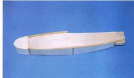
8) Le fuselage avant ponçage. Il faudra bien arrondir les angles.
