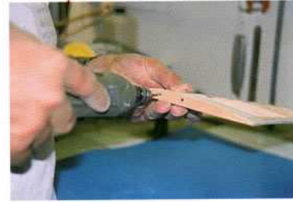
38) Perçage pour les tourillons d'incidence optionnels et le passage de la clé.
