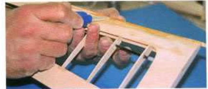
34) Collage du bord d'attaque en baguette de samba.
