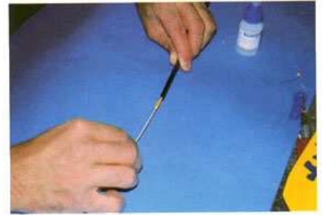
18) Mise en place de la gaine de profondeur. Remarquez le morceau de tube qui l'empêche de flamber.
