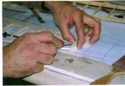
32) Collage des saumons. La partie externe du longeron dépasse pour une plus grande solidité.
