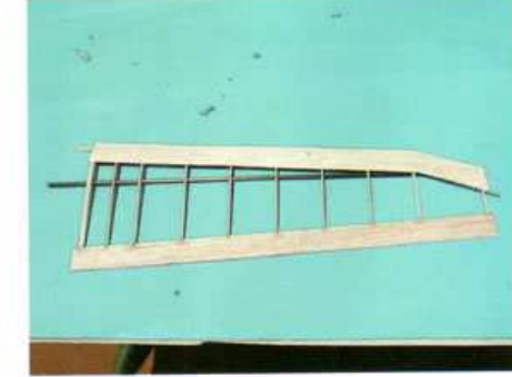
30) Pose du coffrage d'extrados sur la partie avant.
