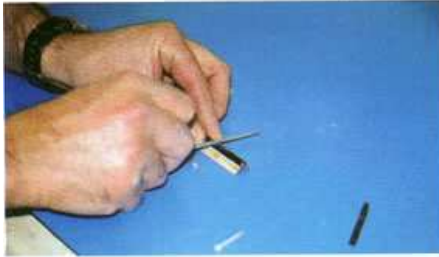
16) Le dessous est poncé pour recevoir un écrou \varnothing 2 mm.
