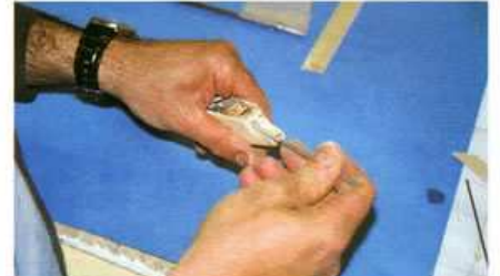
9) Perçage pour le passage des commandes d'ailerons.
