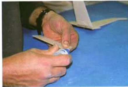
19) Pose des renforts en contre-plaqué sur les volets de stab.
