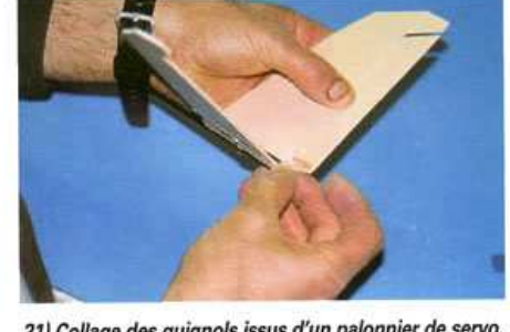
21) Collage des guignols issus d'un palonnier de servo. Ils peuvent aussi être découpés dans du contre-plaqué fin.
