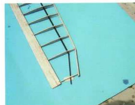
28) Le longeron dépasse du bout d'aile afin de maintenir plus fermement le saumon.
