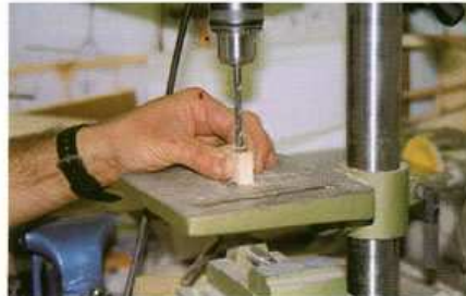
5) Perçage bien dans l'axe à l'aide d'une perceuse à colonne.
