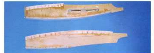
3) La platine est collée dès maintenant. C'est elle qui donnera sa forme au fuselage.
