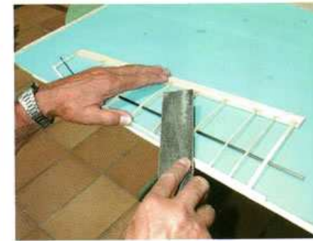
29) Ponçage du faux bord d'attaque, sans abîmer les nervures.
