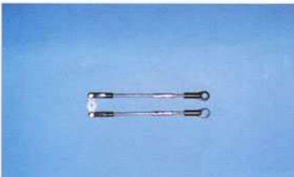
10) Détail des tringleries d'ailerons terminées pour des chapes à rotule démontables.
