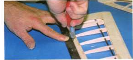
35) Découpe des ailerons après ponçage de l'aile.
