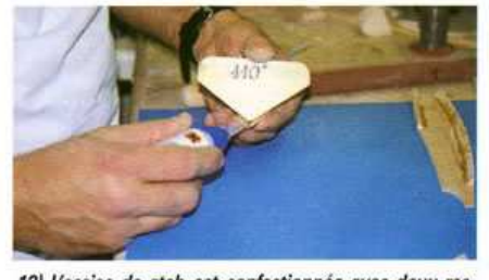
12) L'assise de stab est confectionnée avec deux rectangles de contre-plaqué 6/10 collés en formant un angle à 110°.
