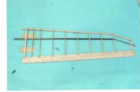
27) L'aile prend forme. Le faux bord d'attaque est collé.
