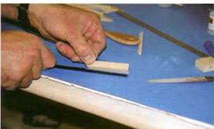
13) Ajustage du support de stab sur l'arrière de la poutre.
