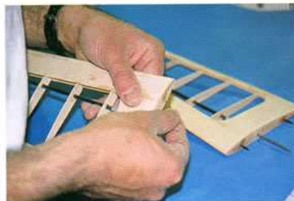
40) Le passage des tubes est renforcé par un manchon.
