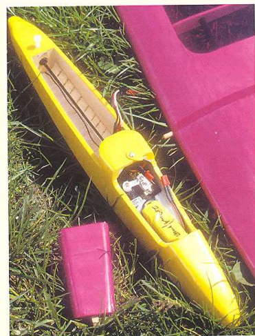
Coooooo! Testpilot Sebastian liebt dichte Vorbeiflüge. Bild rechts: Klassische Flächenbefestigung mit Dübel und Nylonschraube. Miniservo, Empfänger und der 270-mAh-Akku sitzen in der Rumpfnase. Gut zu sehen ist auch die anstelle des Bowdenzuges verwendete CFK-Schubstange. Bild unten links: Gut Holz! „Tito“ im Rohbau.
