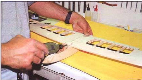
36) Perçage du bord d'attaque de l'aile à travers le couple, pour placer le tourillon en carbone de 3.
