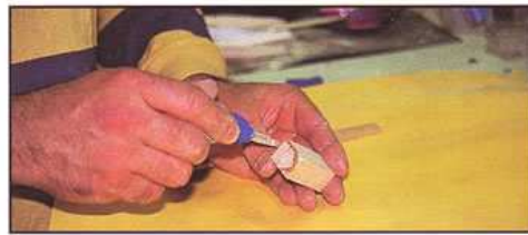
26) Le couple arrière est collé sur le bloc balsa.
