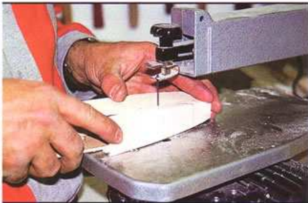
31) Le fuselage est coffré fibres en travers puis la verrière est découpée.
