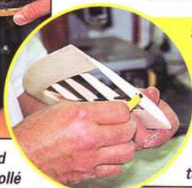
7) Une cale de 3 cm est glissée sous la nervure au niveau de la cassure du dièdre. La nervure d'emplanture peut alors être collée en s'aidant d'une équerre.
