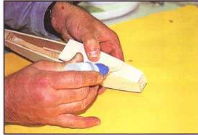
32) La verrière est pointée à la cyano pour être profilée en même temps que le fuselage.
