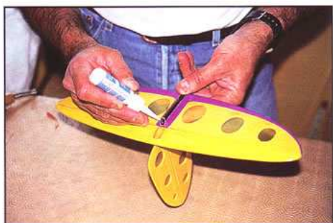
40) On colle d'abord le stab sur la poutre.
