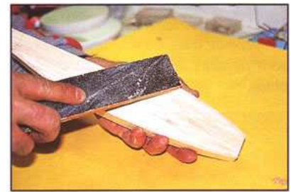
33) Le fuselage peut être poncé. On collera le bloc de balsa formant la pointe du fuselage.
