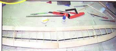
10) Les panneaux intérieurs sont alors collés contre ceux extérieurs en respectant le dièdre.
