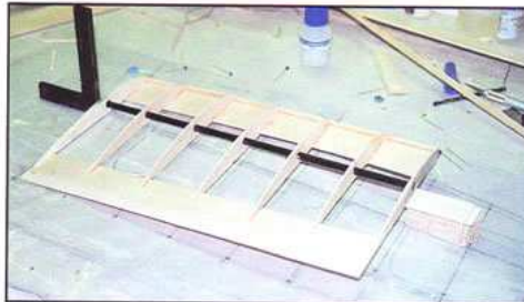
7) Une cale de 3 cm est glissée sous la nervure au niveau de la cassure du dièdre. La nervure d'emplanture peut alors être collée en s'aidant d'une équerre.
