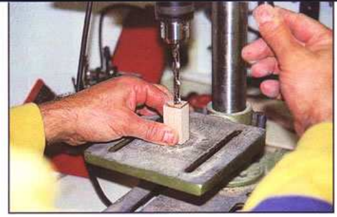
27) Perçage du trou pour le passage de la poutre.
