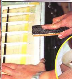
6) Le faux bord d'attaque est collé contre les nervures. La courbe se fait toute seule. Il est ensuite poncé dans le prolongement des nervures, tout comme le bord de fuite.
