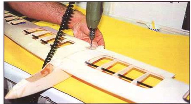
37) Perçage de l'aile pour placer la vis de fixation. Une plaque (S) en contre-plaqué supportera l'écrou noyé.
