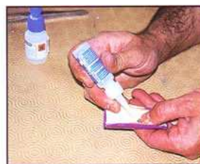
42) Des morceaux de contre-plaqué sont collés pour caler la verrière, ainsi qu'une "queue de cochon" qui servira à accrocher l'élastique de fermeture.
