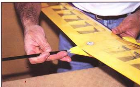
41) La poutre sera collée sur le fuselage avec l'aile en place pour bien aligner l'ensemble.
