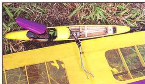
40) On colle d'abord le stab sur la poutre.
