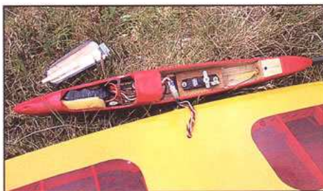
41) La poutre sera collée sur le fuselage avec l'aile en place pour bien aligner l'ensemble.
