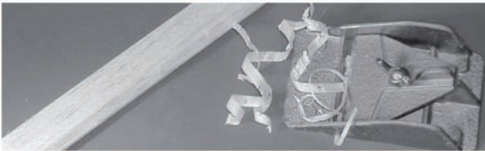
L'aure partie est rabotée et poncée sur toute sa longueur pour former l'aileron et lui permettre de débattre vers le bas.
