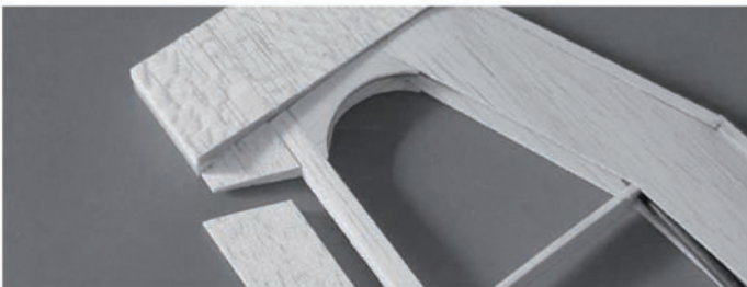
Découper le bord de fuite (46) en biseau. La petite partie est collée contre le faux bord de fuite et le saumon.
