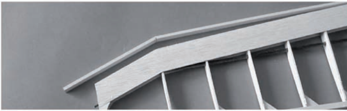
Coller le bord d'attaque (44) encoché pour qu'il suive l'angle.
