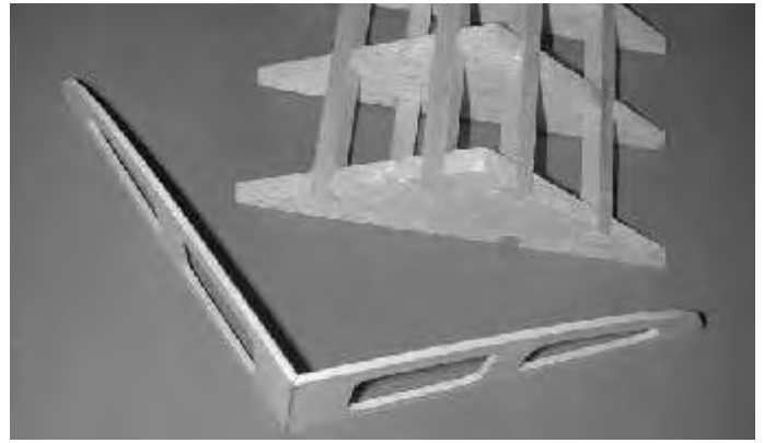
Coller l'empennage avec une ouverture à 110°.
