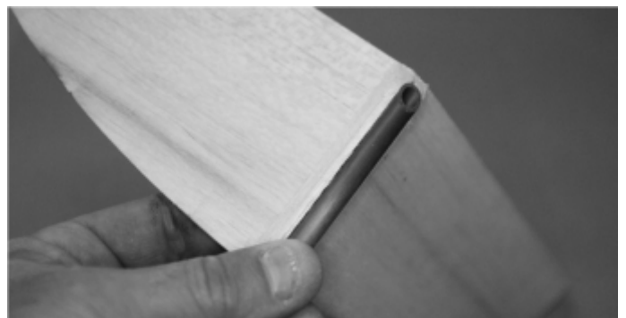
Biseauter le bord d'attaque des volets de stab (3) pour permettre leur débattement vers le bas. Coller les renforts (4) au niveau du guignol.
