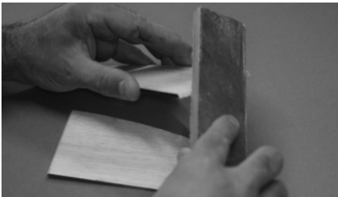
Arrondir le bord d'attaque des demi-stabilisateurs (1). Poncer l'emplanture en biseau.
